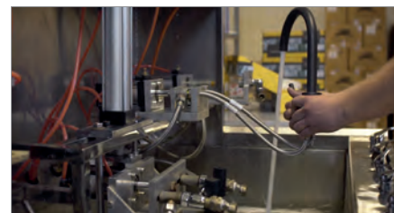
Testování tlakovou vodou
