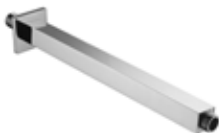
Držák hlavové sprchy hranatý držák hlavové sprchy (ze stropu), délka 300 mm, 25 × 25 mm, pochromovaná mosaz
